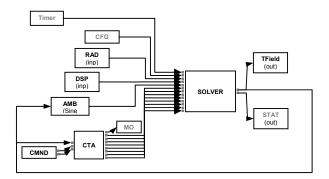
Para el módulo de Control Térmico Activo (CTA) se utilizó el mismo código fuente que se integra en la computadora de a bordo del instrumento. Esto permite no validar el concepto de diseño sino además verificar código fuente final.
