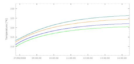
Se puede observar la evolución en cuatro de los nodos de censado. En la figura siguiente se ve la evolución de estas temperaturas simulando las cargas ambientales y su variación con el ciclo orbital sin sistema de control.
