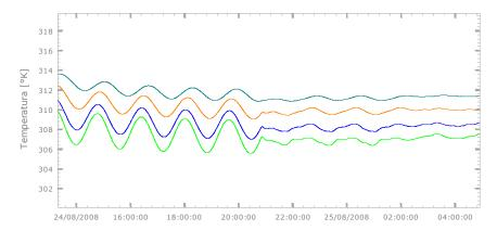
En el período observado se activa el sistema de control con un ajuste preliminar de ganancias. En la última figura se repite el mismo escenario pero con un ajuste mas adecuado del controlador.
