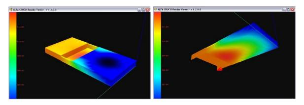
Siendo esta un proceso distribuido su dinámica es infinito-dimensional. Se decidió resolver el problema mediante un control de las condiciones de borde, montando celdas de control en la periferia del radiador.
