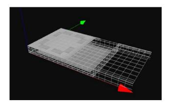
Las fuentes de calor y las superficies de radiación se definen de forma independiente al mallado, indicando para cada una sus propiedades geométricas y térmicas. El mallador se encarga de identificar cuales son los volúmenes abarcados por cada una mediante cálculos de intercepción geométrica, y realizar las asociaciones correspondientes. Lo mismo aplica para la definición de condiciones de borde.
