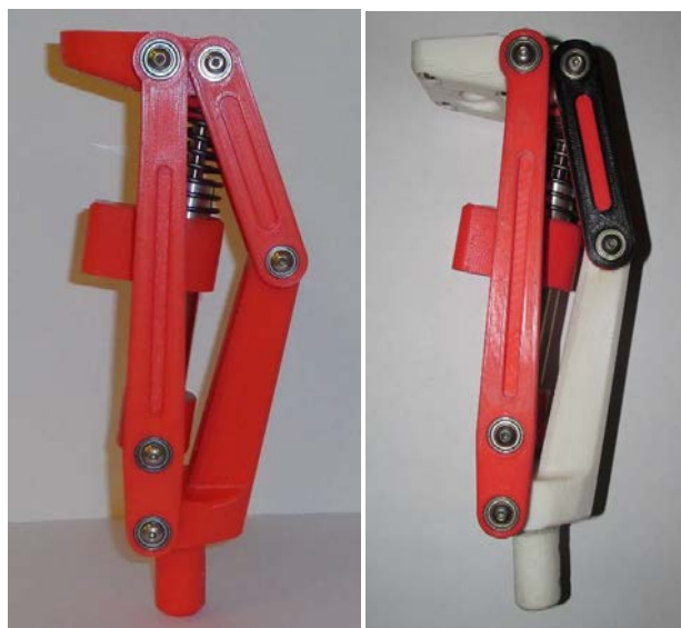
Figura 9: Primer y segundo prototipo de rodilla construido
