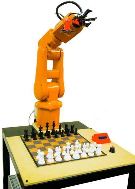
**Figura 1.** Brazo robótico de 6 grados de libertad.
