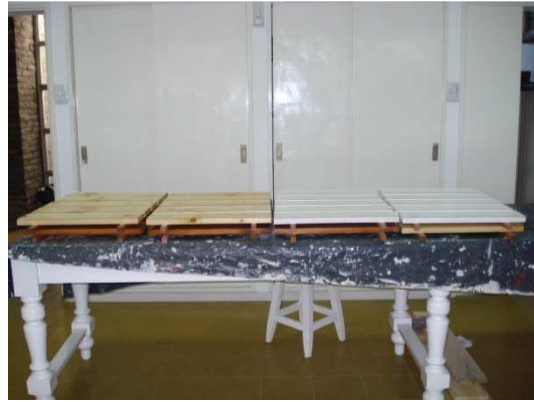
Imagen 13. Armado de bastidores
