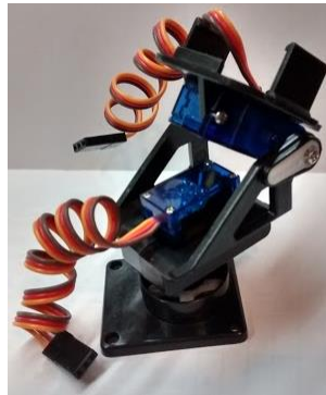
Fig. 4. Base de montura para la Raspberry PI con la cámara integrada – Sensores en dos Ejes
