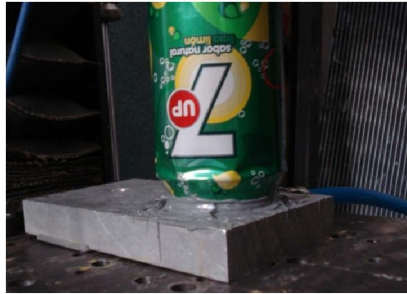
Figura 5. Pandeo local por momentos de chapa inducidos en los extremos de la lata
