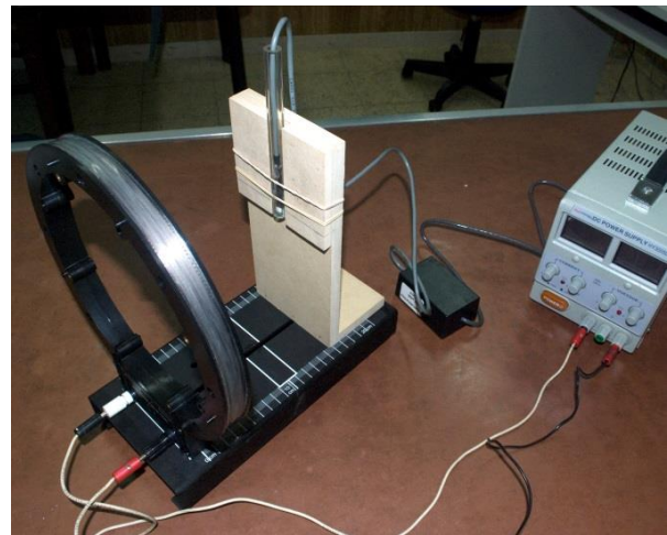
Figura 2. Diseño ingenieril para medición de intensidad de campo magnético producido por una corriente que circula en una bobina, a lo largo del eje.
