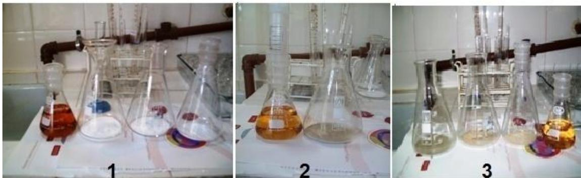
**Figura 4.1**-Empleo de  $\gamma\text{-Al}_2\text{O}_3$  en el medio de reacción 1- *medio de reacción antes de la adsorción sobre  $\gamma\text{-Al}_2\text{O}_3$*  2- *Filtrado obtenido luego del primer contacto sobre  $\gamma\text{-Al}_2\text{O}_3$*  3- *Filtrado del medio de reacción luego del 3er contacto sobre  $\gamma\text{-Al}_2\text{O}_3$*
