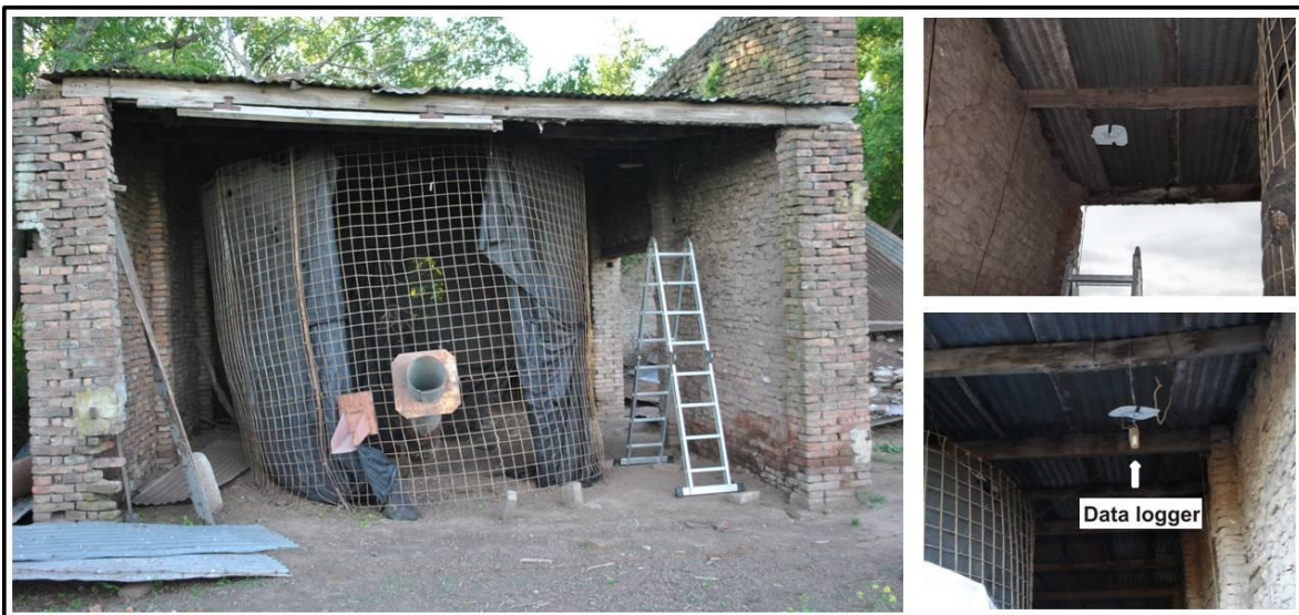
Figura 3-13 Galpón utilizado, en la provincia de Córdoba, donde fue colocado el sensor “control”. Vista general. Der-abajo: “data logger” colocado cercano a uno de los laterales, protegido de la insolación directa.
