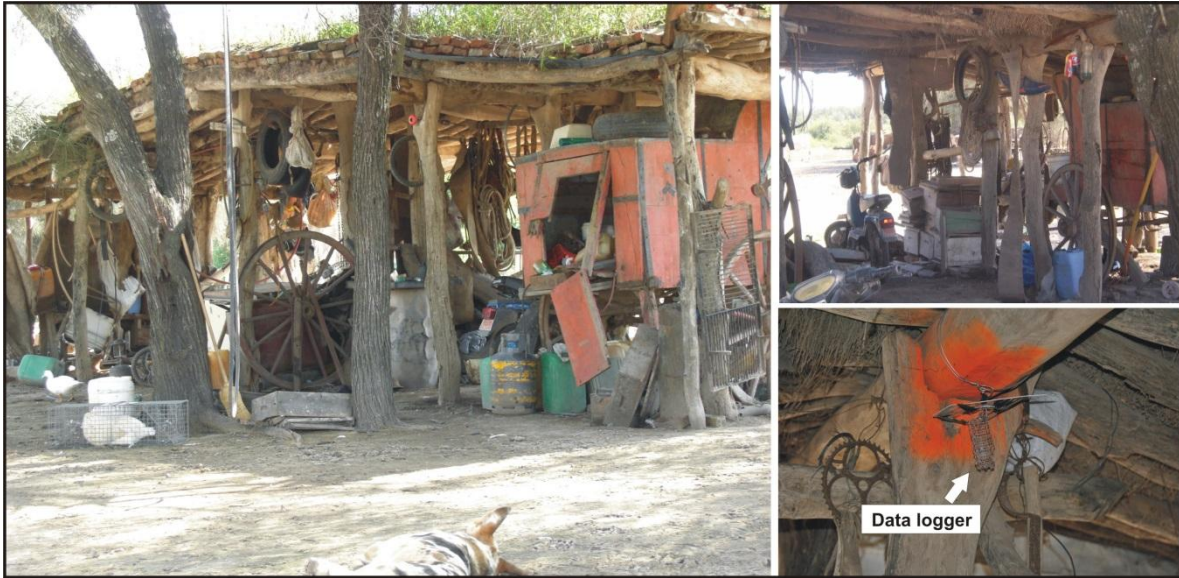
Figura 3-8 Alero en la provincia de Chaco donde fue colocado el sensor “control”. Vista general. Der-abajo: “data logger” colocado cercano a uno de los laterales, protegido de la insolación directa.
