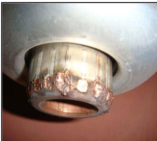
Fig. 4-(a). Contacto móvil fase R
