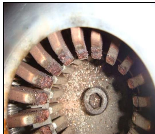
Fig. 4-(b). Contacto fijo fase R
