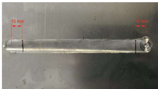
Figura 3: esquema de corte de probetas para el análisis micrográfico.
