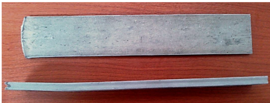
Figura 3: Placas deformadas en caliente
