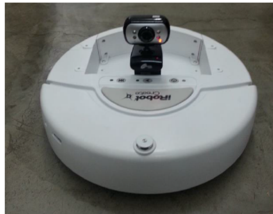
Figura 1 Robot Create de iRobot con cámara inalámbrica utilizado en el taller
