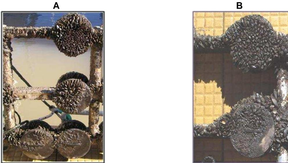
Figura 8.- Aspecto del bastidor con probetas a/c 0,25.
