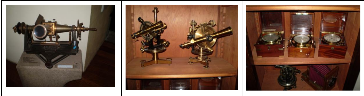
Figura 4 - Alguns dos instrumentos preservados no Observatório Central: luneta equatorial Gautier (1907); teodolito magnético Chasselon (início do século 20) e cronógrafo Fevarger (início do século 20). Fonte: Acervo Observatório Central.
