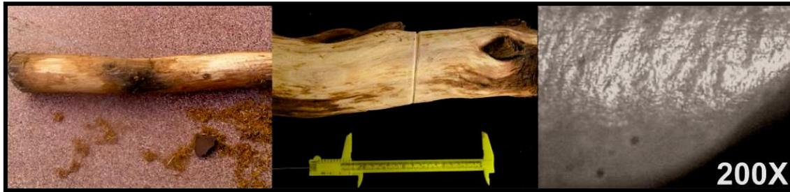
**Figura 117:** Trabajo sobre madera dura (estacionada) de manera transversal (raspado) 60' de trabajo.
