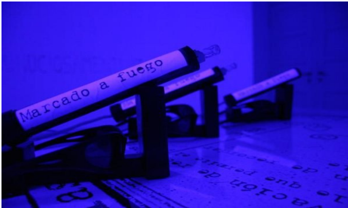
Imagen 1: Lapiceras hechas con pedazos de manguera, y una lámpara halógena, que escribía en el papel termosensible.
