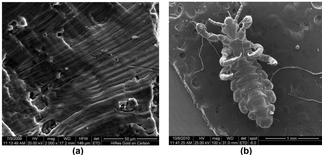
**Figura 5.** (a) Superficie de fractura de una muestra de Aluminio, (b) Imagen de un *Pediculus humanus* comúnmente denominado piojo.
