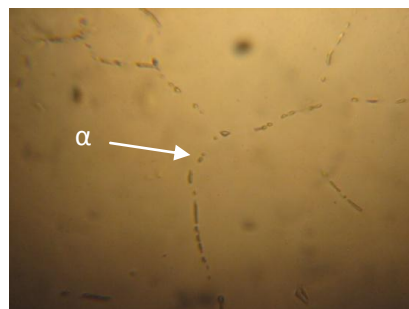
Fig. 2b. Estructura refinada luego del homogeneizado-solubilizado. Se aprecia la fase \alpha -AlFeSi fragmentada.
