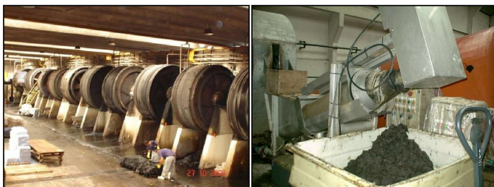
Figura 2. Fulones de procesamiento de pieles (derecha) y residuo pelo proveniente de un depilado conservador del pelo (izquierda)
