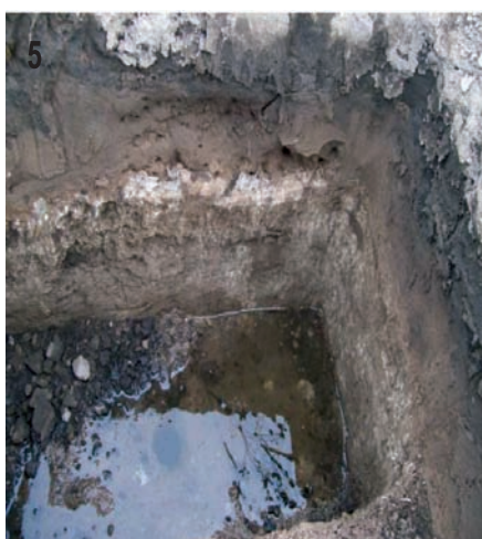
Foto 5: perfil de suelo con presencia de napa a 100cm.
