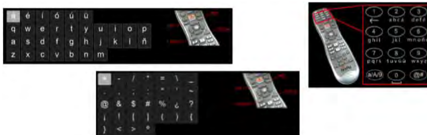
Fig. 1. Disposiciones de caracteres especiales. En la parte superior izquierda teclado virtual QWERTY que incluye vocales con tildes. En la parte inferior central, juego complementario de caracteres especiales para teclados virtuales. En la parte derecha, juego de símbolos modificado para el método Multitap y botones de acceso para la escritura de otros caracteres especiales.
