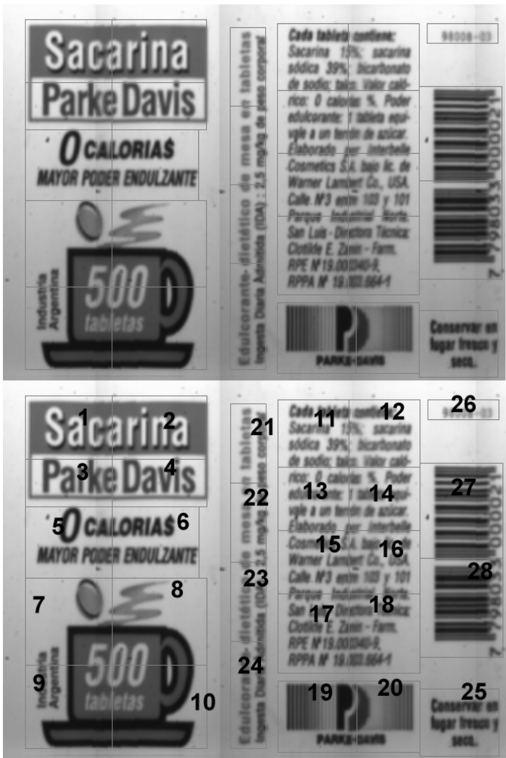
Figura 7. Imagen patrón y motivos a inspeccionar en la impresión de cada envase
