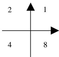
El método implementado por esta componente se basa en la siguiente idea: para cada punto  $p$  de la estructura regular, desplazar el eje de coordenadas en dicho punto y obtener la isolínea más cercana a  $p$  para cada uno de los cuadrantes con centro en él.
