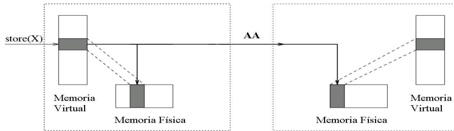
Figura 4: Mecanismo de actualización automática para interfaces mapeadas a memoria virtual.
