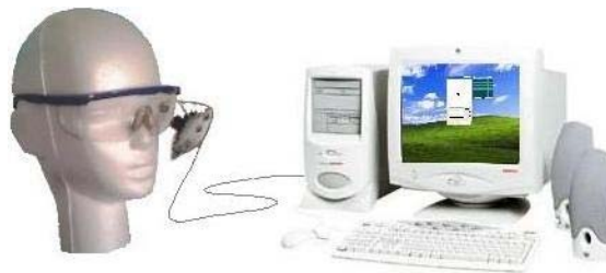
Figura 1: Sistema de Escritura y Habla por medio del Movimiento Ocular [1]
