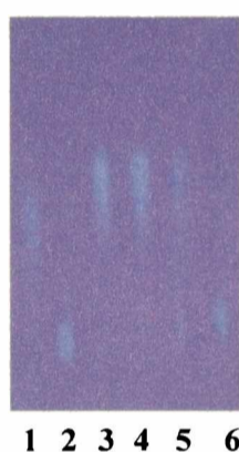
Figura 14.9: Corrida de TLC. Calles 1: solución patrón de FPT (50 \mu\text{M} ). Calle 2: solución patrón de CPT (100 \mu\text{M} ). Calle 3: solución patrón de HPT (180 \mu\text{M} ). Calles 4 a 6: solución de HPT ( [\text{HPT}]_0=180 \mu\text{M} ; pH=5,5) irradiada 10, 20 y 25 minutos, respectivamente.
