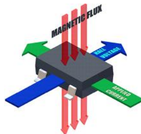
Gambar 2.4. Prinsip kerja sensor efek hall
