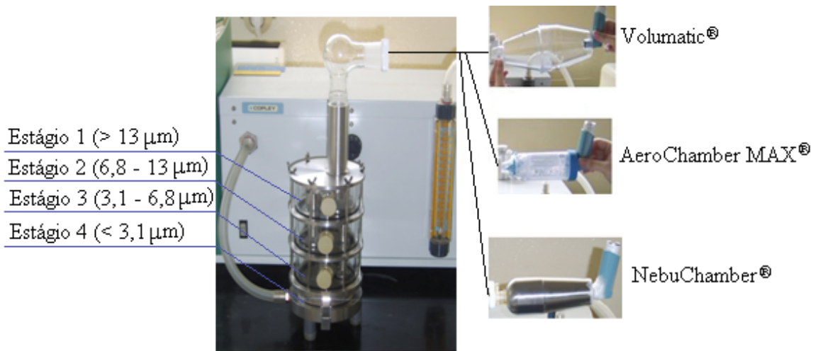
Fig. 3 - Representação do Impinger Líquido de vários estágios (MSLI) observando-se a correspondência dos quatro estágios de acordo com o tamanho aerodinâmico de deposição das partículas (para 60 l/min). Visualizam-se também as três câmaras de expansão testadas.
