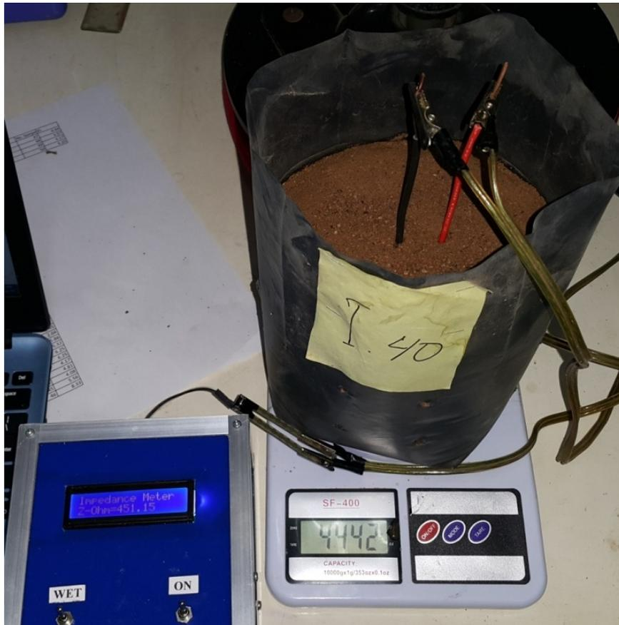
Gambar 1. Teknik pengukuran Z untuk tanah dalam polibag
