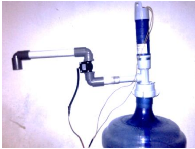
Gbr. 15 Sensor Waterflow dan Pompa
