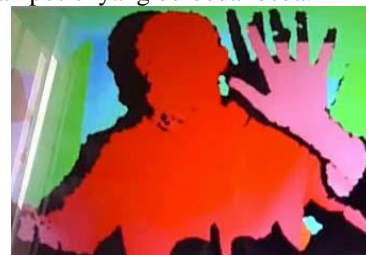
Gambar 6. Pemetaan Objek Dengan Depth Sensor [6]
