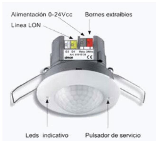
**Figura 3. 5 Conexión sensor luminosidad**
