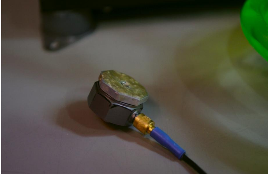
Ilustración 2 Acelerómetro con cera de abeja aplicada en la base
