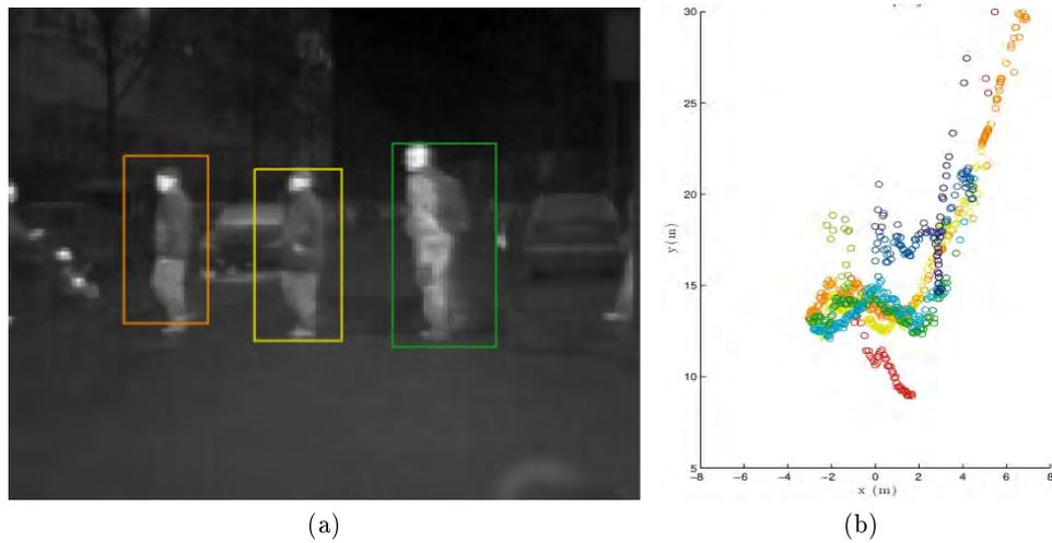
Figura 1.8: Detección de peatones en imágenes infrarrojas (a) y la correspondiente estimación de las trayectorias de los mismos (b), como se presenta en Olmeda (2013).
