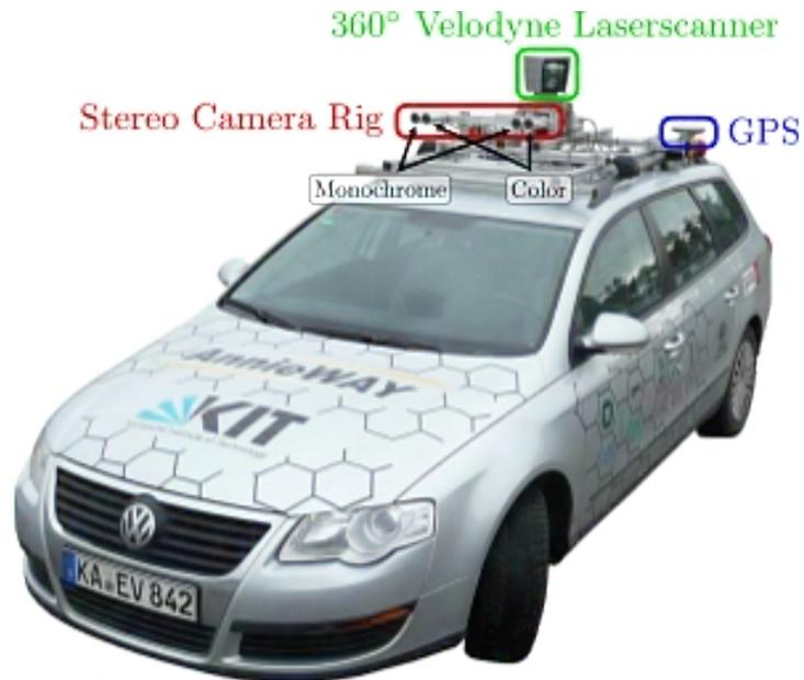
Figura B.1: Plataforma de investigación utilizada para la generación de la base de datos de acceso público Geiger et al. (2012).
