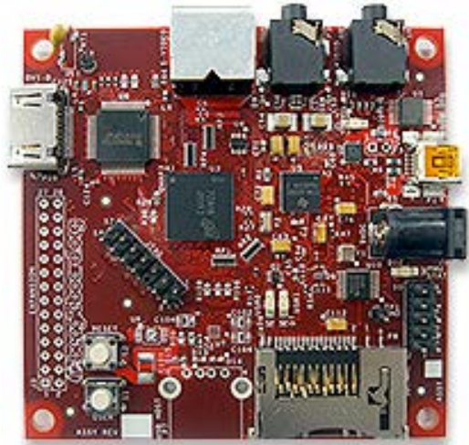
Figura 3.6: Sistema hardware BeagleBoard
