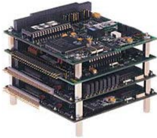
Figura 3.4: Sistema hardware basado en el estándar PC 104
