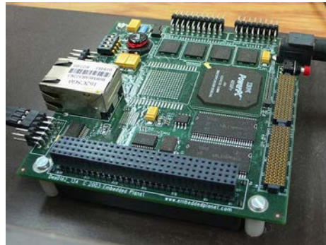
Figura 2.5: Computador en placa única basado en estándar PC 104
