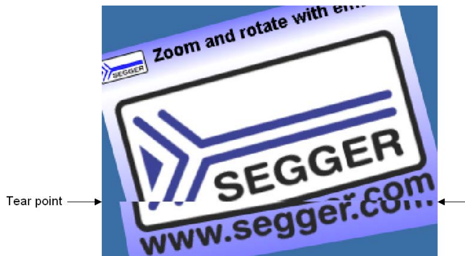
Figura 5.30: Ilustración del efecto de 'tearing' al dibujar en una pantalla
