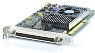
Figura 2.11: Sistema RCP DS1104 de dSPACE® para ordenadores PC
