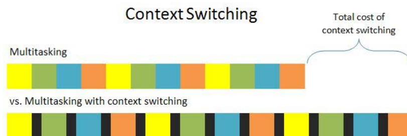
Figura 5.20: Efectos sobre el tiempo total de ejecución del cambio de contexto en un RTOS. Fuente: Documentación FreeRTOS
