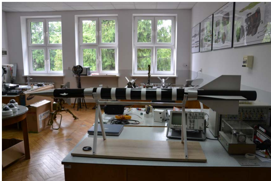
Figura 8.21: Misil de prácticas gobernado por el sistema ARCP con MCU STM32F4. Fotografía cortesía del ejército de tierra polaco y del cabo Marcin Chodnicki
