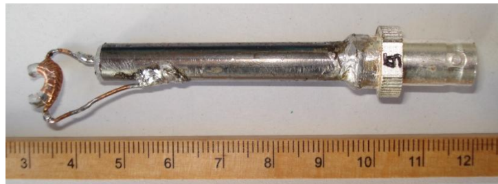
Figura 4.12: Sonda 5: Multiespira con semiferrita Fair-Rite TX 10/6/3-4C65 según [Joh'99]
