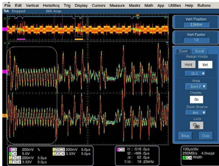
Figura 7.13: Variación espectro captado al variar un bit de la clave
