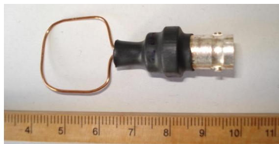
Figura 4.9: Sonda 2: Monoespira cobre esmaltado 0.8 mm según [Smi'99]
