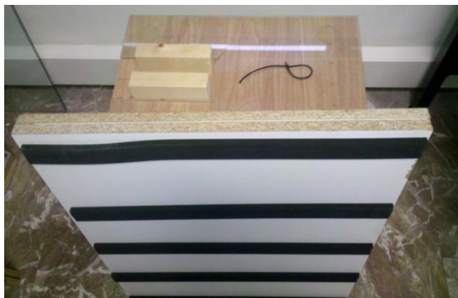
Figura 4.56: Base mesa test setup: detalle elastómeros
