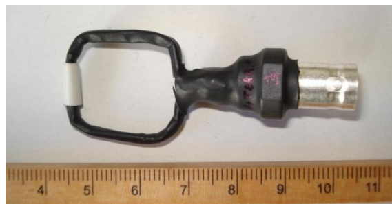
Figura 4.10: Sonda 3: Monoespira blindada cobre rígido y termorretráctil según [Smi'00]
