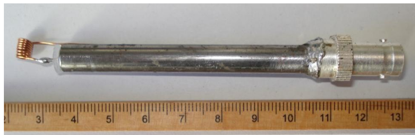
Figura 4.13: Sonda 6: Multiespira (8 espiras) cobre esmaltado 0,6 mm según [Pee'07]
