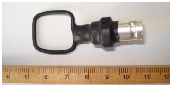
Figura 4.8: Sonda 1: Monoespira con un clip y termorretráctil según [Smi'99]
