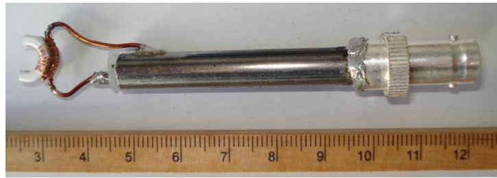
Figura 4.11: Sonda 4: Multiespira con semiferrita Fair-Rite TN 9/6/3-4C65 según [Joh'99]
