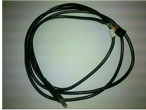
Figura 4.42: Cable TTL-232R para la señal de encriptación
