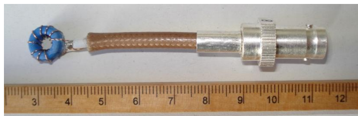
Figura 4.14: Sonda 7: Sonda multiespira con ferrita TN10/6/4-3F3 según [Rid'99]
