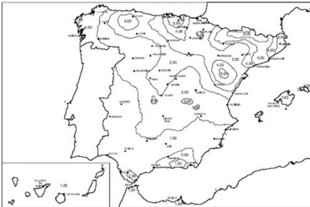
Figura 15. Mapa de densidad de impacto sobre el terreno N_g (Fuente: Catálogo C.T.E)
