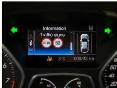
**Figura 2.5:** *Display* con la información obtenida sobre las señales de tráfico de la vía, Sistema de Identificación de Señales.
