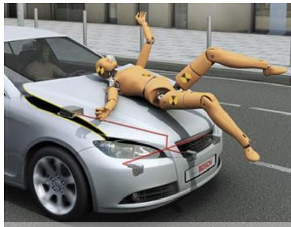
**Figura 2.7:** Capó elevable para la protección del peatón [20].
