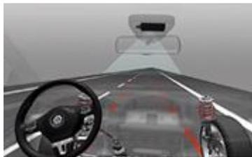
**Figura 2.3:** Sistema de Mantenimiento de Trayectoria en el Carril [15].
