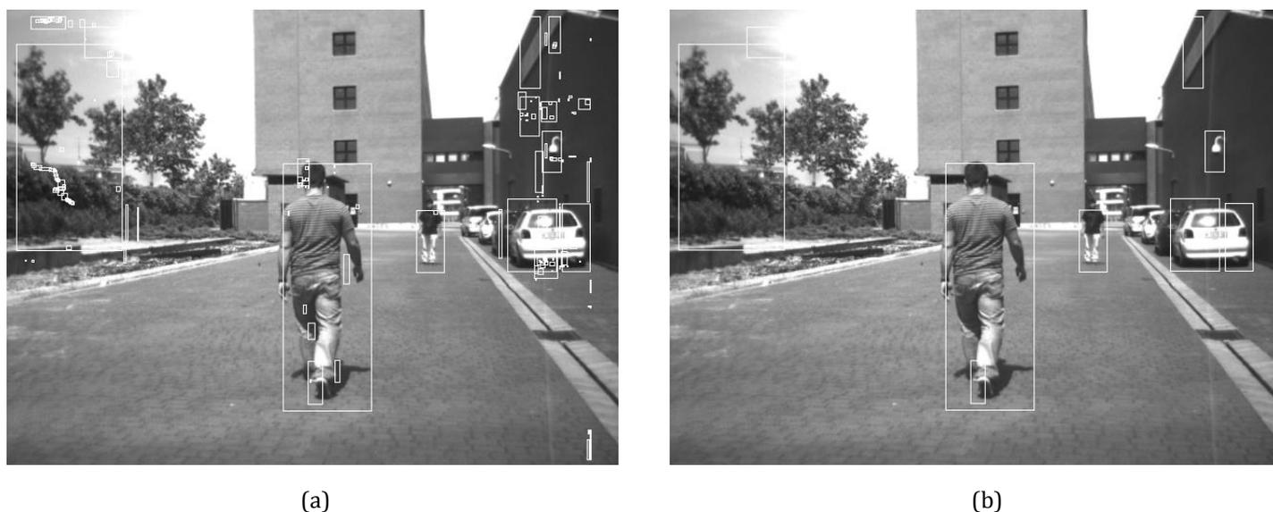
**Figura 4.4:** Representación de las ROIs obtenidas (a) sin descartar aquellas de área más pequeñas, (b) después de descartar aquellas ROIs que por su tamaño no pueden englobar a un peatón.
