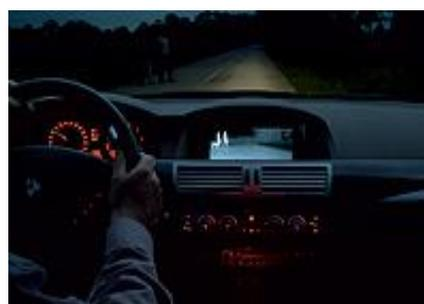
**Figura 2.2:** Sistema de Visión Nocturna [10].
