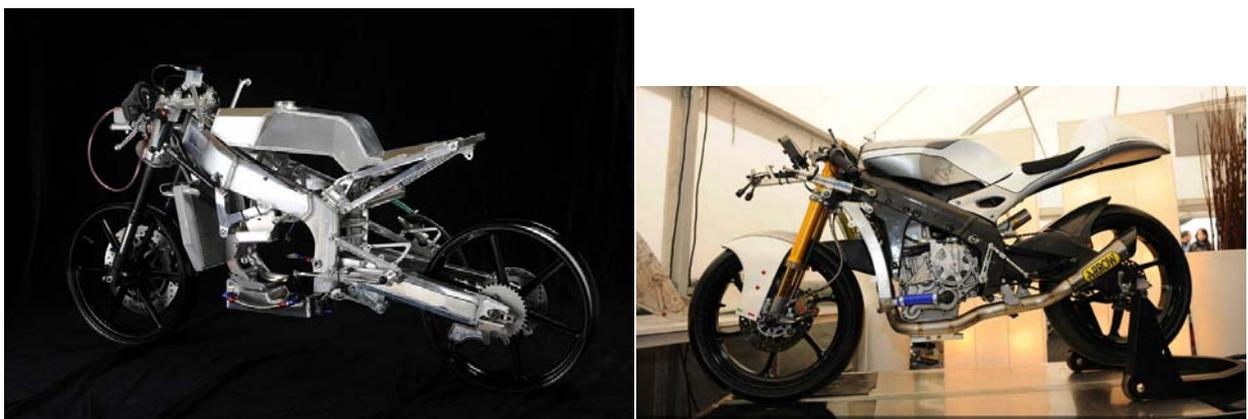
Ilustración 28: Chasis Yamaha (aluminio) y Aprilia (fibra de carbono) diseñados para la categoría de Moto3
