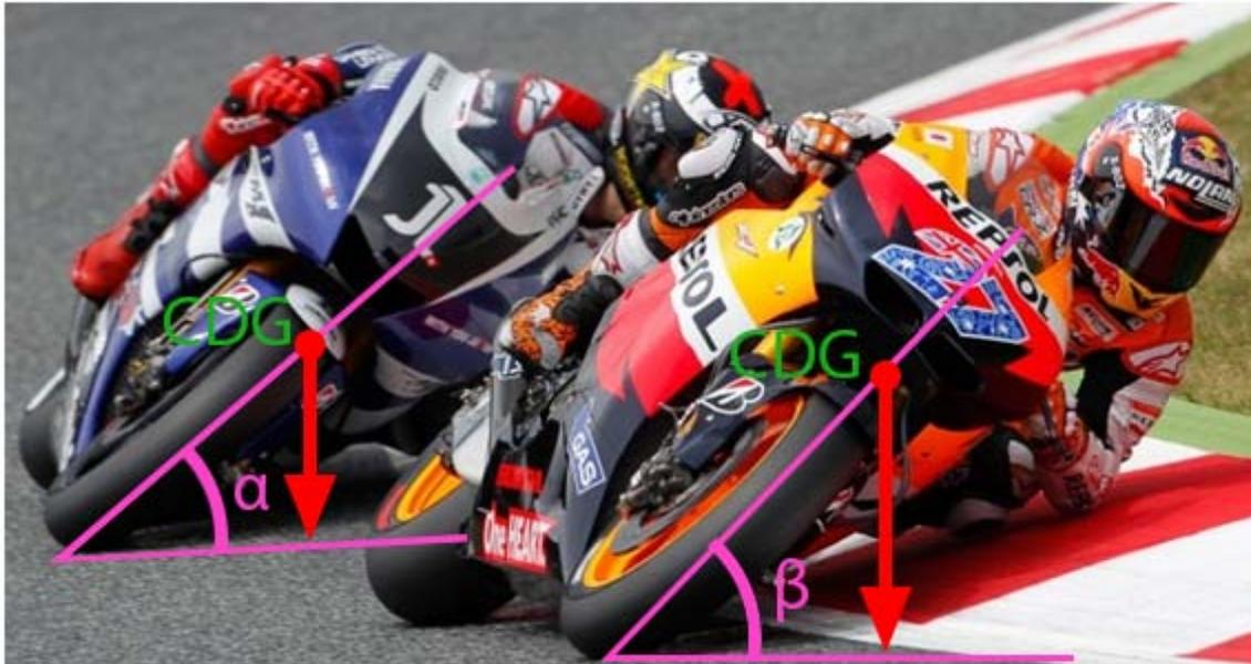
Ilustración 34: variabilidad del CDG en función de la inclinación ([www.motogp.com/es](http://www.motogp.com/es) [11])
