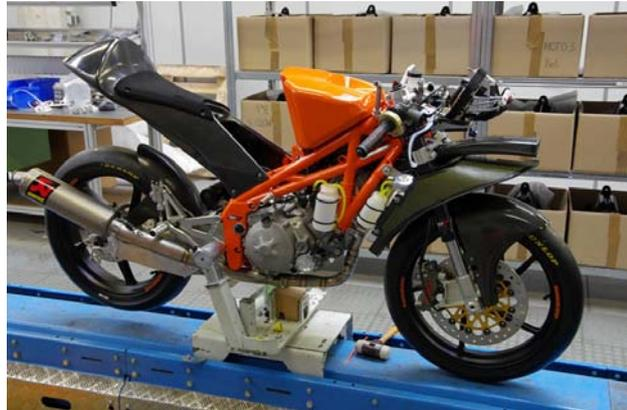
Ilustración 118: Ram-air con toma de aire por debajo de la pipa de dirección
