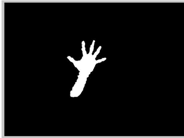
Figura 6.3: Proceso de umbralización estática con  $T_1 = 220$  y  $T_2 = 255$ .
