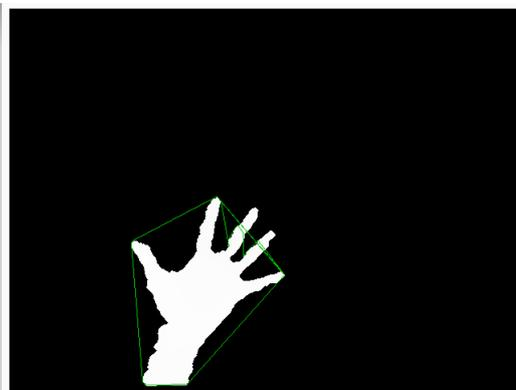
Figura 6.15: Obtención del Convex Hull incorrecta mediante el segundo método.
