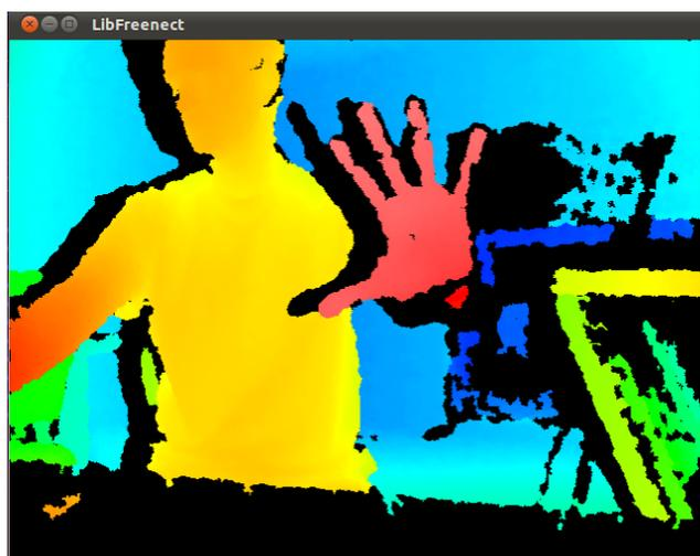
Figura 4.19: Imagen de profundidad de Kinect donde se observan los píxeles negros creados tanto por sombras como por distancia excesiva a la cámara.
