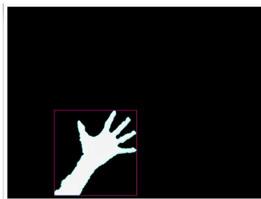
Figura 6.11: Aplicación de `ofxContourFinder` a la imagen segmentada.
