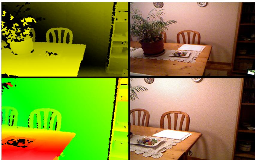
Figura 5.3: Imágenes obtenidas mediante OpenNI arriba y Libfreenect abajo.
