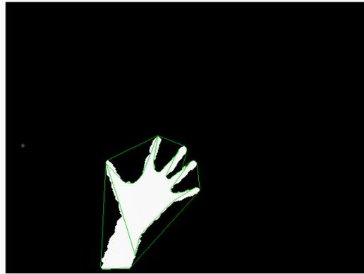
Figura 6.14: Obtención del Convex Hull incorrecta mediante el primer método.
