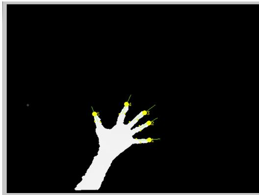
Figura 6.20: Dirección de los dedos en verde y puntos para calcularla en amarillo, utilizando la ecuación 6.5.
