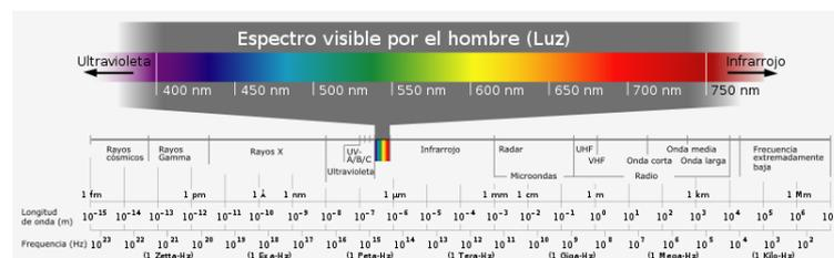
Figura 4.1: Espectro electromagnético y luz visible en detalle.
