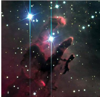
Figura 4.6: Fenómeno de *blooming* con CCD's. Se observa que la saturación se produce en vertical debido a la manera en la que se recoge la información en el chip.
