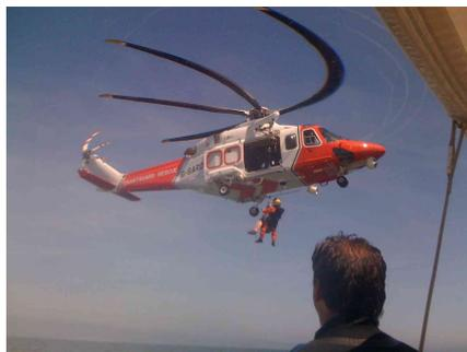
Figura 4.7: *Rolling shutter* en imágenes en movimiento. Se puede apreciar cómo las aspas del helicóptero aparecen deformadas.
