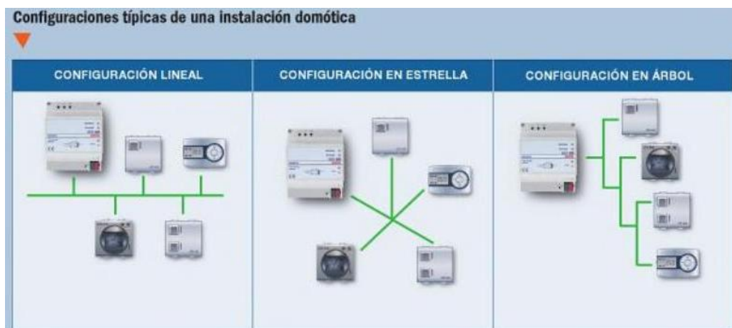
Figura 9. Configuraciones típicas de una instalación domótica
