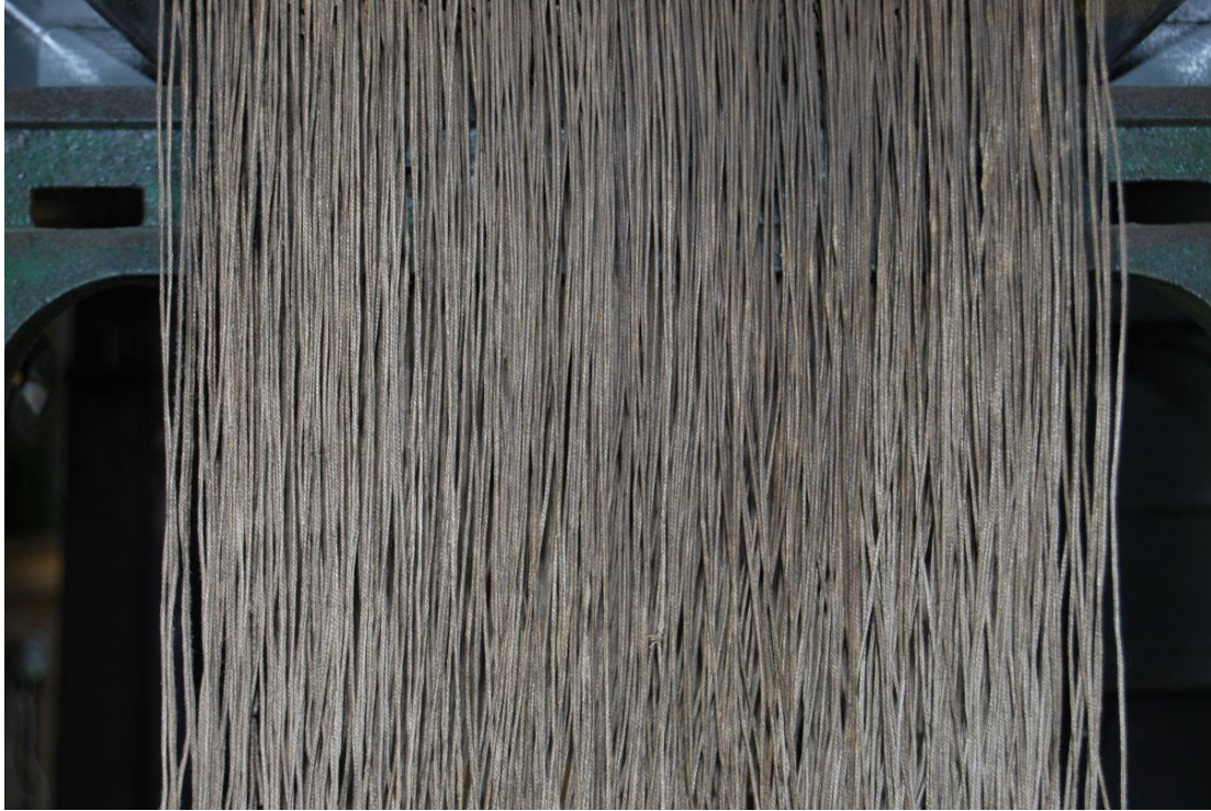
Figura 2.1 Fibras de vidrio saliendo directamente de una máquina textil.
