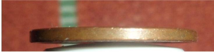
*Figura 4.1. Simulación de la posición de la moneda cuando cae a bajo  $Re$ . Su diámetro es perpendicular al flujo de vaselina.*
