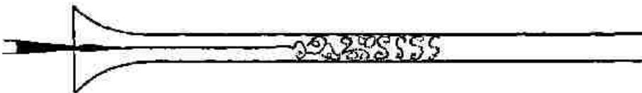
*Figura 2.3. Aspecto del flujo turbulento habiendo sometido al tubo a una chispa de luz. Se pueden observar los remolinos que hace el flujo*
