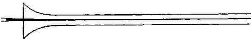
*Figura 2.1. Aspecto del flujo laminar en el ensayo de Reynolds*
