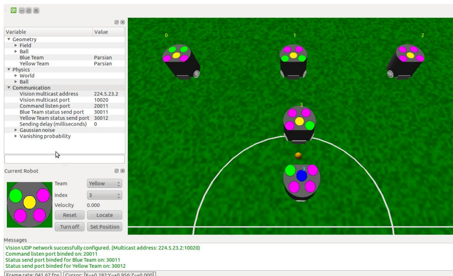
Ilustración 56: robots en el simulador grSim [7] [15] con 3 ruedas
