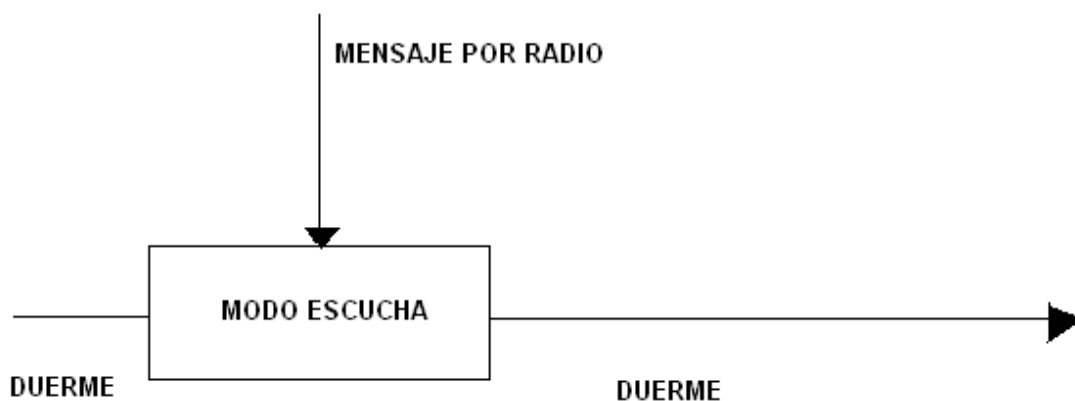
Figura 1: Ciclo de trabajo de la radio
