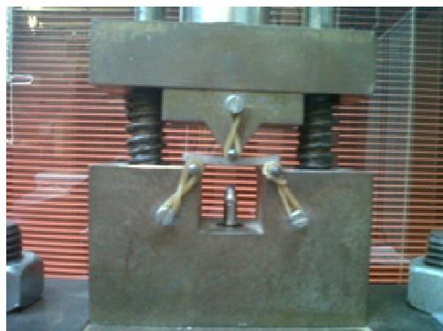
Figura 11 Disposición de los elementos en el ensayo de flexión en tres puntos
