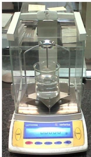
Figura 9 Disposición del ensayo de Arquímedes
