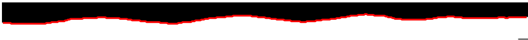
FIG. 12: - Detección de interfase. El algoritmo de detección permite determinar aquellos puntos que son frontera en la imagen binarizada, estos puntos frontera se corresponden con la interfase líquido-aire.
