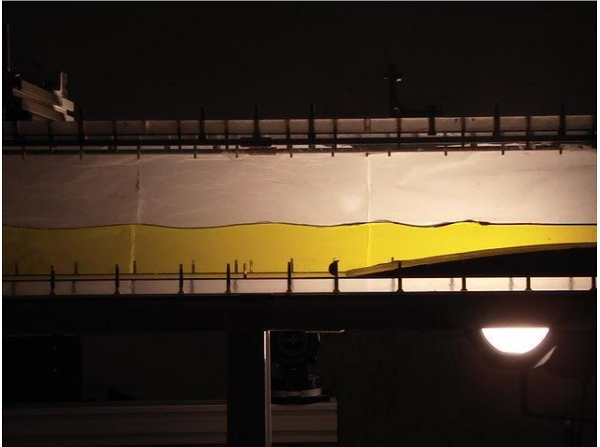
FIG. 8: - Fotograma ejemplo de la primera serie. Imagen de la primera serie tomada mediante iluminación a contraluz. El fluido aparece tintado para potenciar el contraste en la interfase.
