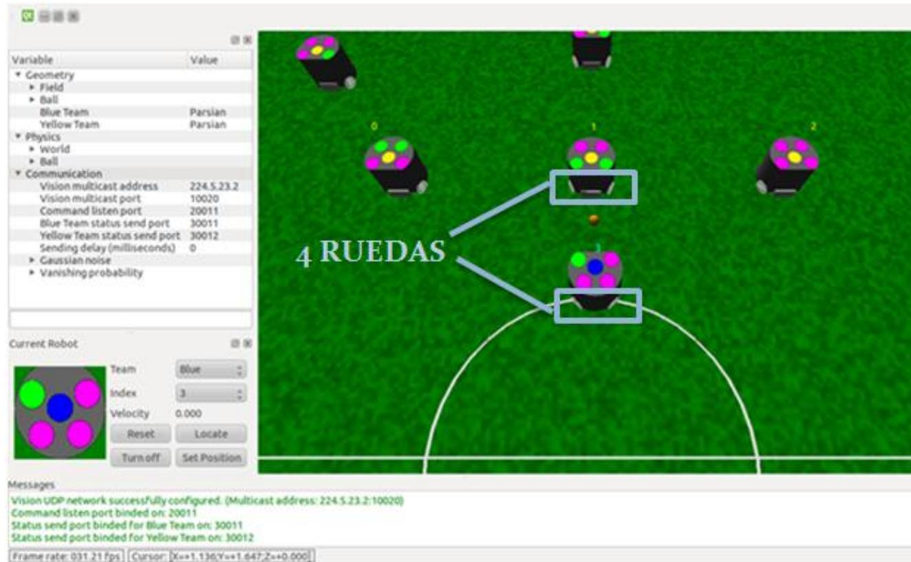
Ilustración 73: representación simulador grSim [7] [8] con robots de cuatro ruedas
