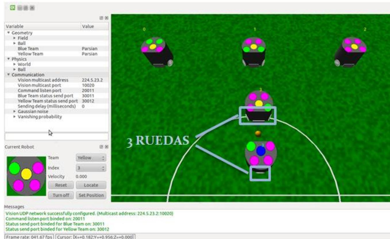
Ilustración 76: representación simulador grSim [7] [8] con robots de tres ruedas
