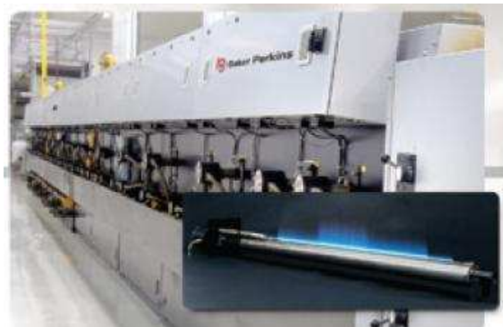
Figura 23. Fotografía de un horno de Gas de Fuego Directo, DGF, de Baker Perkins, ubicado en la Línea de Producción.
