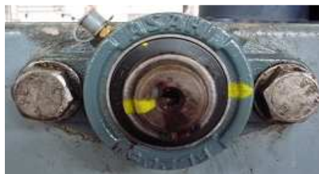
Figura 14. Figura que muestra el rodamiento con la marca para la verificación de giro.
