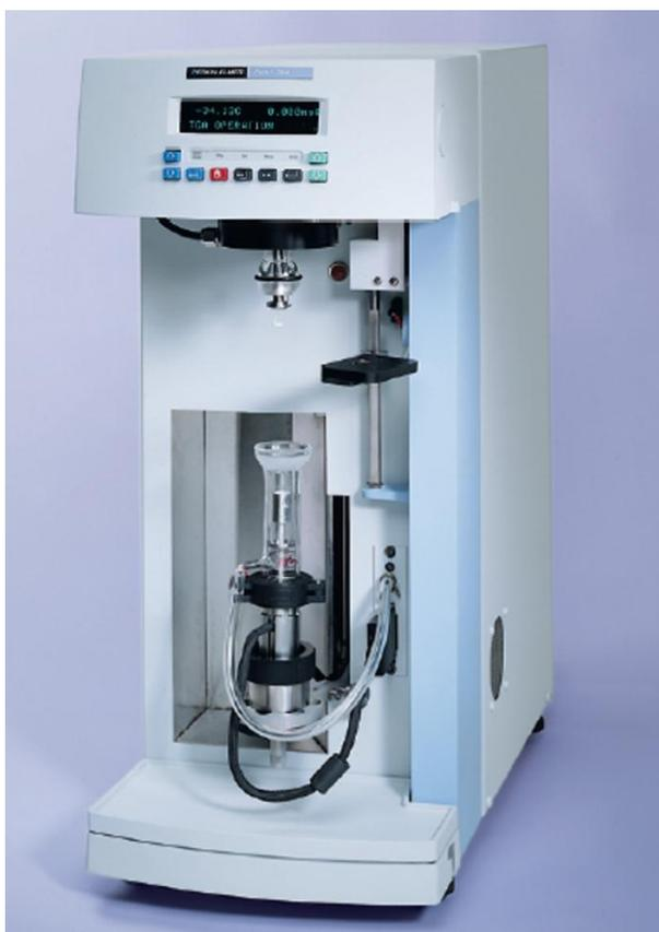
El procedimiento utilizado se basa en introducir una pequeña muestra de nuestra mezcla en una balanza (5-10 mg) y calentamos desde 20°C hasta 600°C a una velocidad de 10°C/min en atmósfera de nitrógeno tomando datos en cada momento de la cantidad de muestra que se mantiene en la balanza (% peso no extraído).
