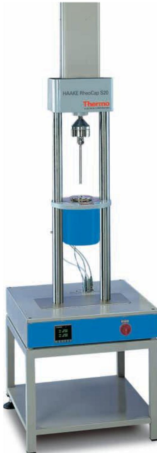
Dicho reómetro es del tipo “reómetro capilar de pistón”. Se rellena un depósito (con forma cilíndrica) con el material del que deseo conocer su viscosidad que está conectado a un capilar de pequeñas dimensiones y de valor del diámetro conocido. Dicho material es calentado durante un tiempo a la temperatura adecuada de tal modo
