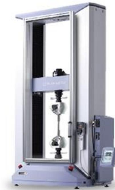
La probeta se amordazaba por sus extremos y se iban separando a una velocidad de 50 mm/min. Los datos que suministraba el ensayo eran:
